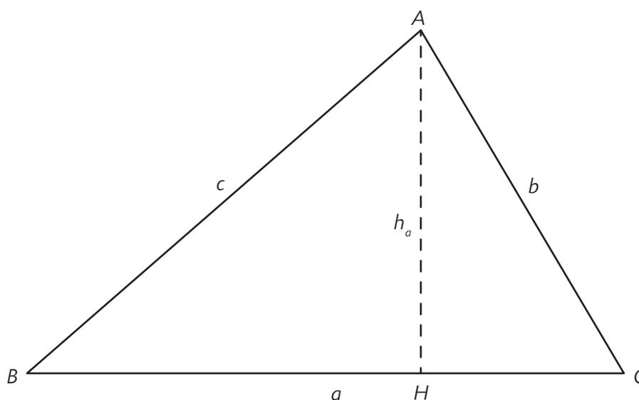
En un triángulo  $ABC$  cualquiera se traza la altura  $h$  correspondiente al vértice  $A$ ; como el ángulo  $AHB$  es recto, resulta
